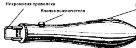
Приспособление для обжига и снятия изоляции при разделке монтажных проводов (термоципсы).
