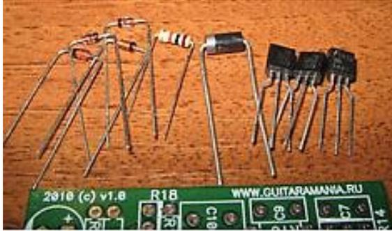
2. Сборка. Детали устанавливаются на плату со стороны надписей, выводы пропускаются в отверстия
